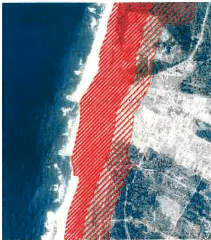
Fig.9 Faixa de Salvaguarda ao Galgamento e Inundação Costeira – Praia do Furadouro
